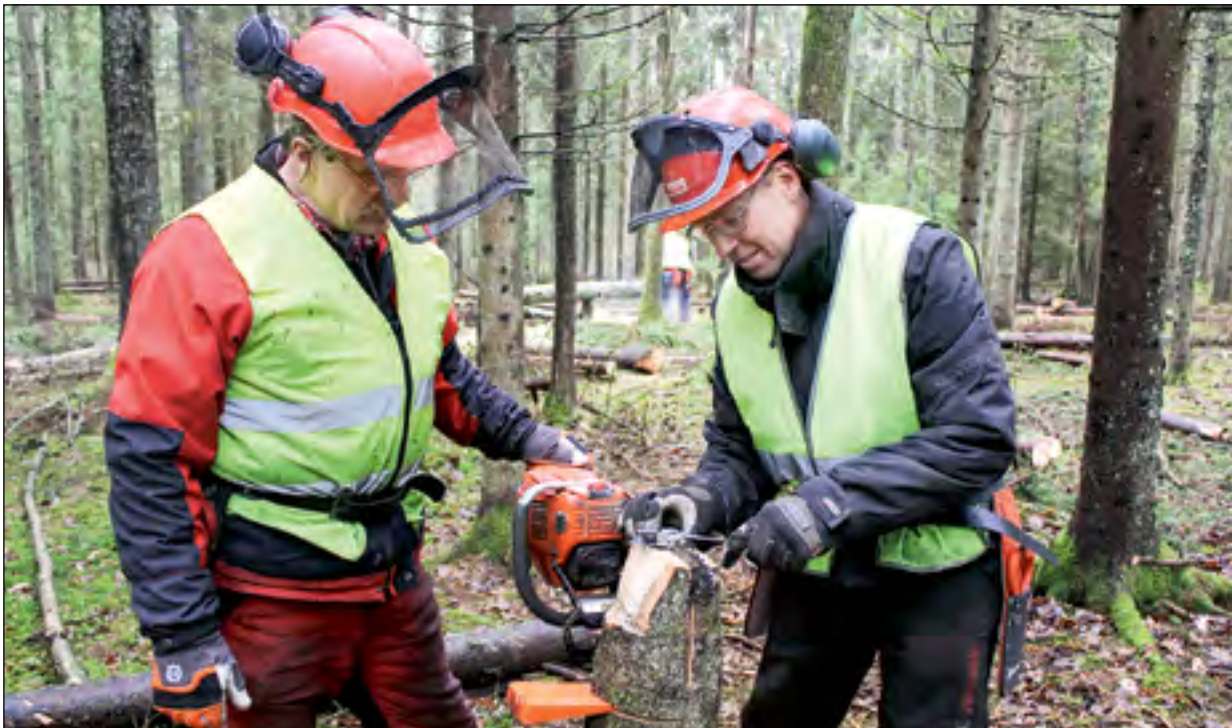
Lennart Eriksson filar sågkedjan i en praktisk och gratis filhållare. Kursledaren Leif Aronsson, säkerhetsombud på Södra övervakar det hela.
